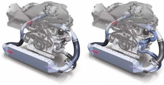
Ladeluftstrecke ohne Unterstützung durch den elektrischen Verdichter Charge air path without the use of the electric compressor
